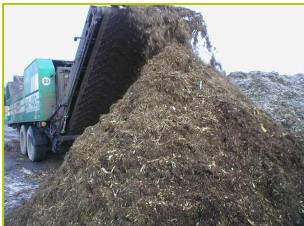
Notons par exemple qu'un broyeur industriel bois-énergie ou compost (loué) peut débiter entre 30 et 150 m<sup>3</sup> de BRF/heure en consommant 0,2 l de diesel/m<sup>3</sup> alors qu'un broyeur (acheté) à branches sur prise de force débitera généralement entre 1 et 5 m<sup>3</sup>/h en consommant entre 1 et 5 l de diesel/m<sup>3</sup> de BRF produit.
