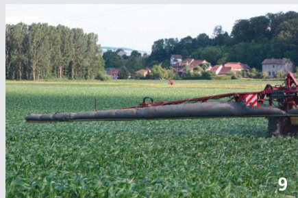
9 Pulvérisateur avec assistance d'air et buses antidérives permettant une application par grosses gouttes sans nuage de pulvérisation.
